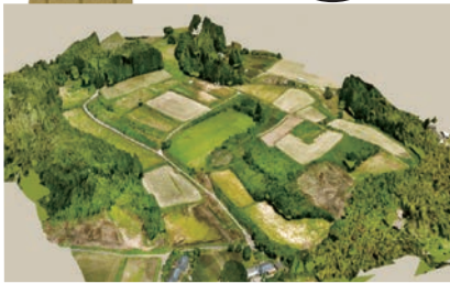
現況図の3次元化 (ドローンによる測量)
