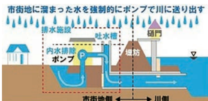
排水機場の仕組み
